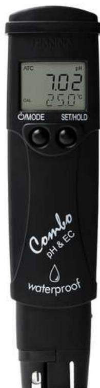
El HI 98130 es un medidor de bolsillo a prueba de agua con el que se pueden realizar mediciones muy exactas de pH, CE/TDS y temperatura en un solo instrumento, ya no es necesario cambiar de equipo en las mediciones de rutina. Este medidor combinado, flotante y a prueba de agua tiene una pantalla LCD fácil de leer y un apagado automático. Las lecturas de pH y CE/TDS cuentan con compensación automática de temperatura.
