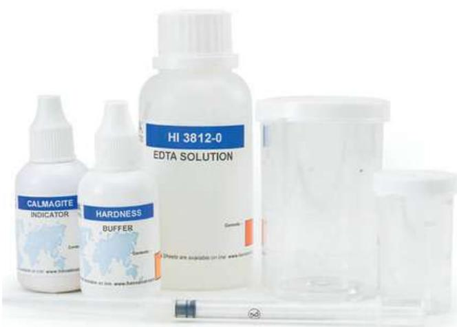
El HI3812 es un kit químico de pruebas basado en la titulación que determina la concentración de dureza total en dos intervalos: 0.0 a 30.0 mg/L y 0 a 300 mg/L. El HI3812 se suministra con todos los reactivos y accesorios necesarios para realizar el análisis. El kit de pruebas contiene suficientes reactivos para realizar aproximadamente 100 pruebas.
