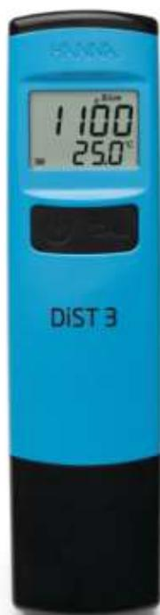
Estos probadores incluyen características tales como: electrodo de grafito reemplazable, relación de TDS ajustable, medición de °C o °F, Compensación Automática de Temperatura. (ATC) con ? ajustable, indicador de nivel de batería, indicador de estabilidad, calibración automática y apagado automático.
